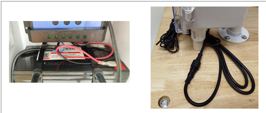
รูปที่ 3-19 การต่อชุดสายไฟของเซลล์แสงอาทิตย์
