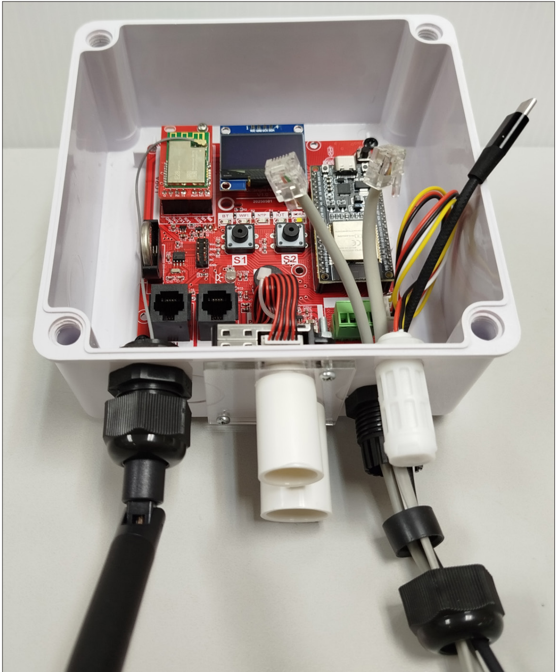
รูปที่ 3-9 การร้อยสายเซ็นเซอร์และสายไฟ USB เข้ากับแผ่นวงจรชุดน้อย LoRa
