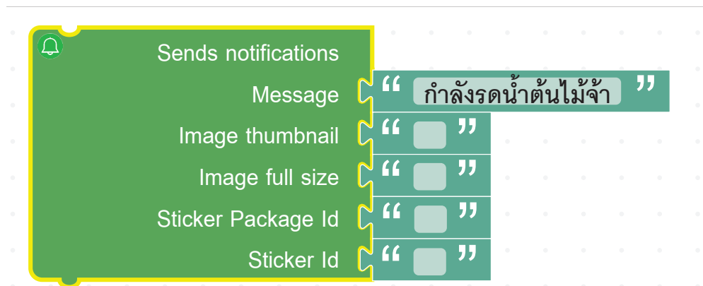
รูปที่ 13 ตัวอย่างการใส่ข้อความลงในบล็อกข้อความสำหรับการใช้งาน LINE Notify
