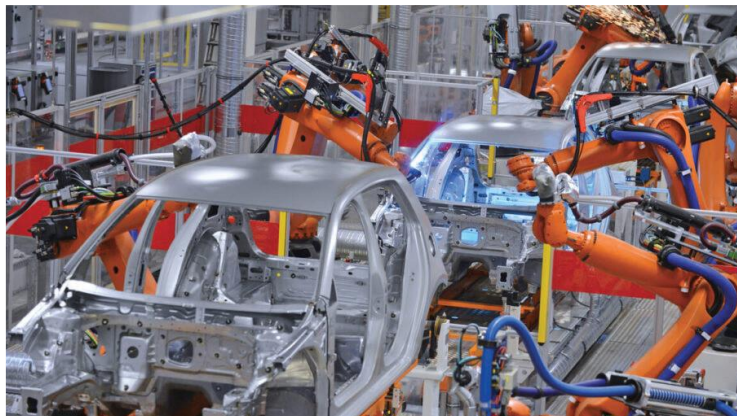
รูปที่ 5.9 การประกอบชิ้นส่วนรถยนต์ด้วยหุ่นยนต์ [30]
