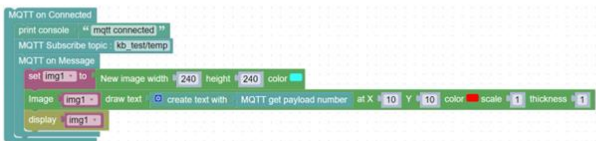
รูปที่ 4.8 ใช้งานบล็อก MQTT on Message ในบล็อก MQTT on connected
