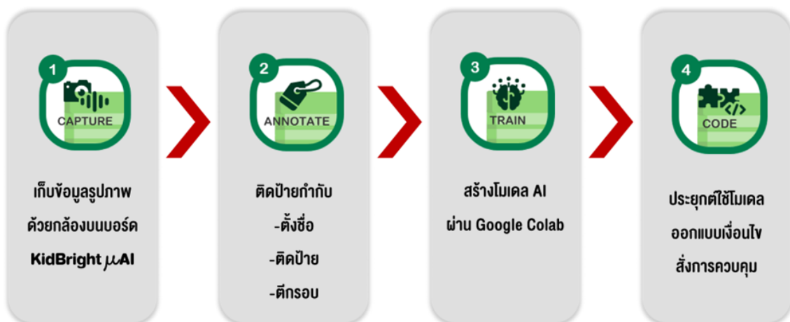
รูปที่ 3.2 แสดงลำดับกระบวนการพัฒนาระบบ AI ด้วย KidBright \mu AI Platform
