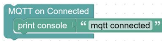
รูปที่ 4.6 โค้ดสำหรับการพิมพ์ข้อความ "mqtt connected" ผ่านบล็อก MQTT on Connected
