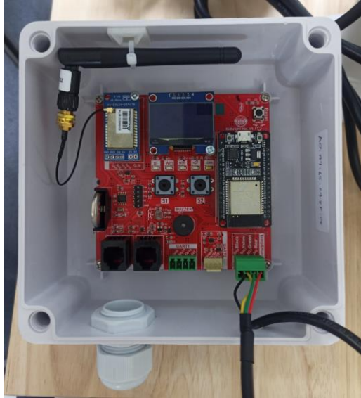
รูปที่ 3-1 การประกอบแผงวงจรอุตุฯน้อย LoRa เข้าในกล่อง
