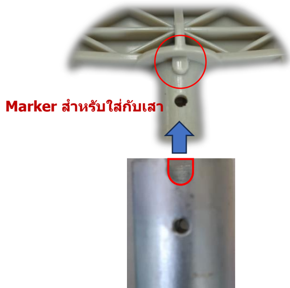
รูปที่ 3-3 การประกอบเสายึดเซนเซอร์วัดความเร็วลม ทิศทางลม เข้ากับเสาเหล็ก ขั้นตอนที่ 4 ประกอบเซนเซอร์วัดความเร็วลมเข้ากับเสายึด โดยให้จุด Marker ของเซนเซอร์สำหรับใส่ U Support ตรงกับ Marker ของ MOUNTING ARM
