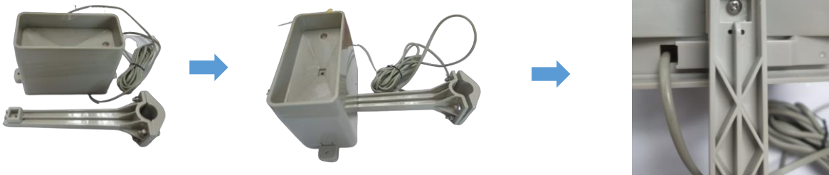
รูปที่ 3-2 การประกอบเซนเซอร์วัดน้ำฝน
