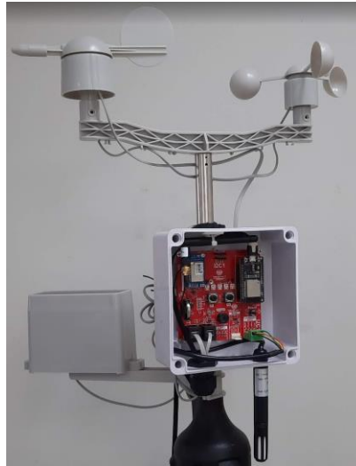
รูปที่ 3-9 สถานีอุทุน้อย LoRa พร้อมเซนเซอร์วัดสภาพอากาศ
