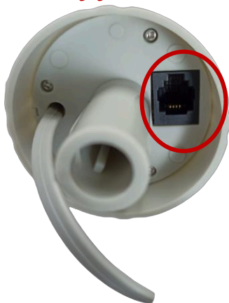
รูปที่ 3-7 จุดเชื่อมต่อสายสัญญาณจากเซ็นเซอร์วัดความเร็วลมเข้ากับเซ็นเซอร์วัดทิศทางลม
